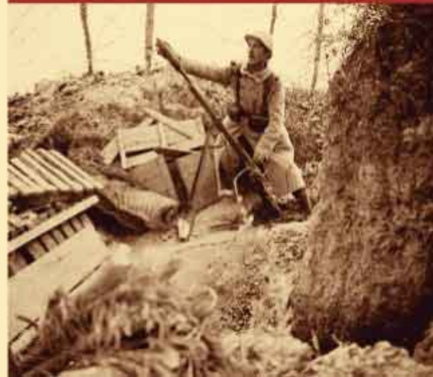
UN FUSIL PEUT ÊTRE TRANSFORMÉ EN LANCE-GRENADES.
